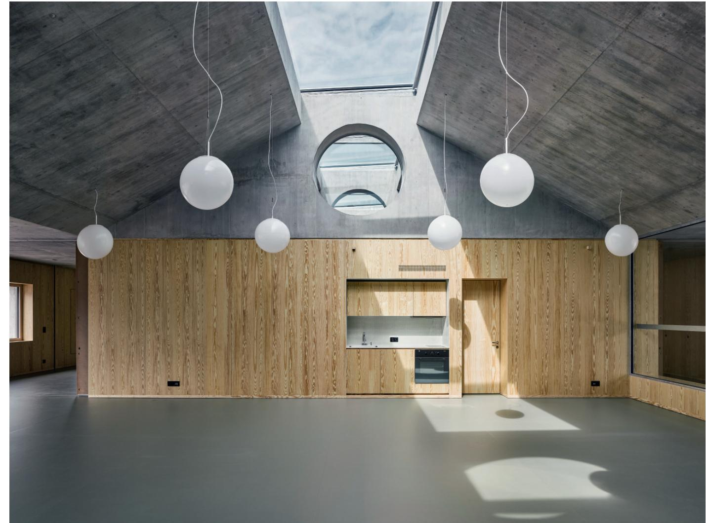
Eine feine, beinahe unsichtbare Mikroperforierung der Holzelemente genügt, um eine gute Akustik zu gewährleisten. Die Einbauten beherbergen nebst der Treppe ein Podest mit Spiecke und Stauraum, sowie darunterliegende WC-Anlagen und Archivräume. Aus der begehbarer Höhe des Zelthauses können die Kinder durch die kreisrunden, verglasten Aussparungen der Betonträger in den benachbarten Kindergarten spionieren. Sie haben alles im Blick.
