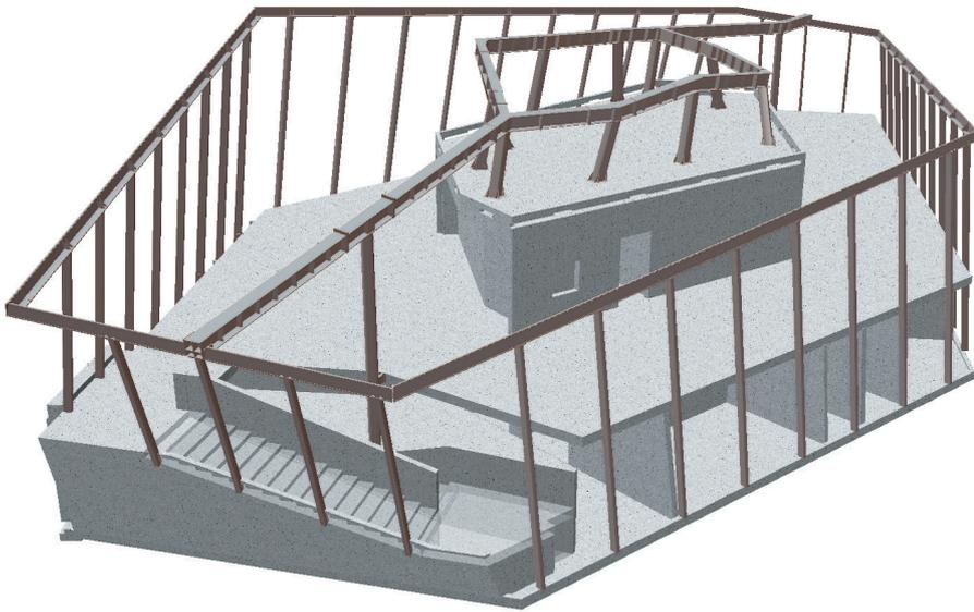
Tragwerk als Hybridkonstruktion
